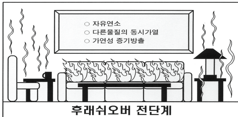
후래쉬오버(Flashover) 이전의 상황
