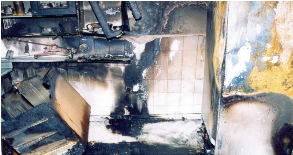
[사진 32] 냉장고 뒤쪽 벽면의 V패턴 (벽체매입콘센트를 중심으로)
