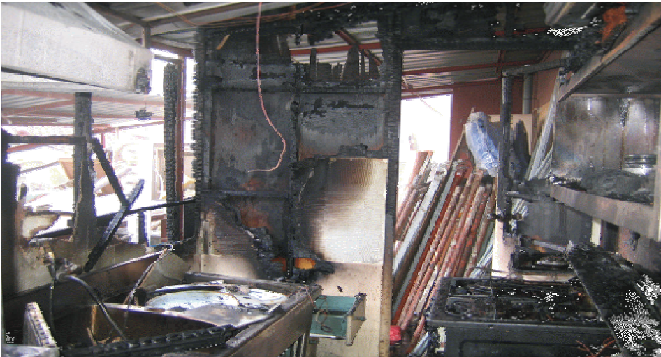
[사진 31] 전자레인지로 중심으로 올라간 화재 패턴
