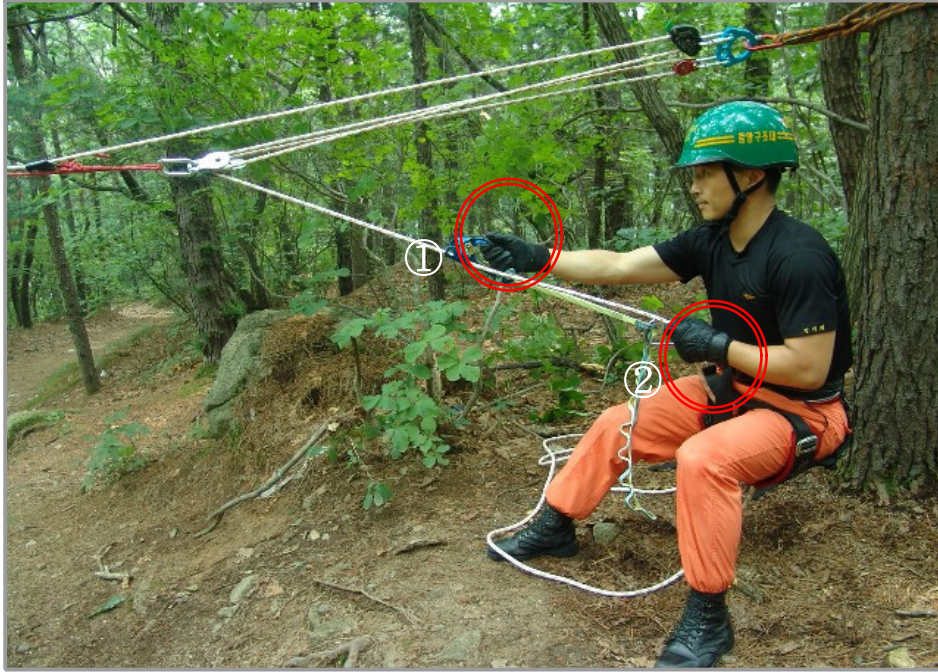
[그림 4-129] 로프당김 (등강기와 띠고리를 이용한 당김)
