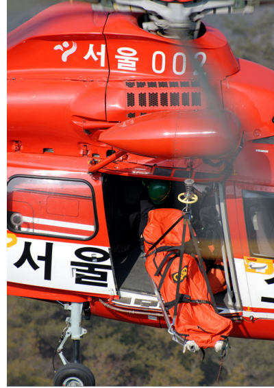
[그림 4-204] 들것이 흔들리지 않도록 지상에서 로프로 잡아 주어야 한다. 들것과 호이스트를 연결하는 로프는 가급적 짧게 하는 것이 좋다.
