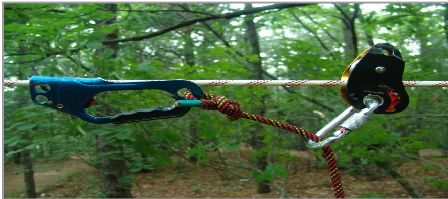
[그림 4-130] 진입장치 설치
