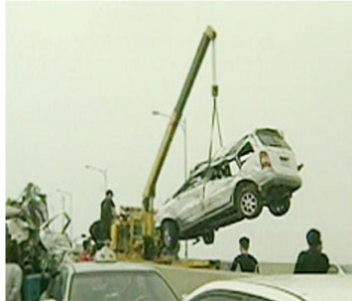
[그림 4-165] 크레인을 이용한 차량 인양
