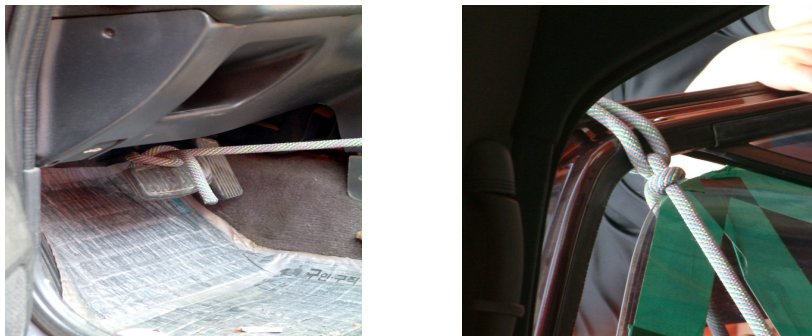
[그림 4-180] 페달에 로프를 묶고 반대쪽 끝은 창틀에 묶은 다음문을 바깥쪽으로 젖힌다.
