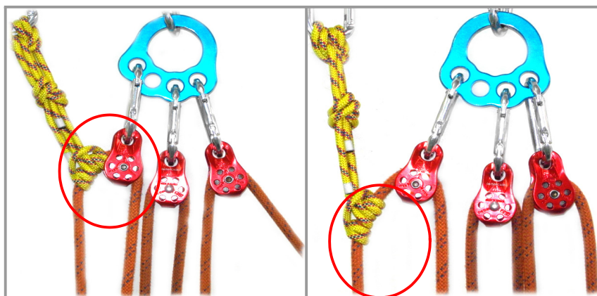
[그림 4-143] 슬링을 이용한 고정방법
