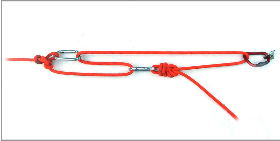
[그림 4-109] 기본 티롤리언 브릿지의 당김 시스템
