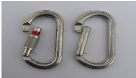
[그림 3-52] 결빙시 강제 개방으로 파손된 개폐구
