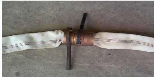
[호스 개폐기(Spanner)를 이용한 소방호스 연결모습]
