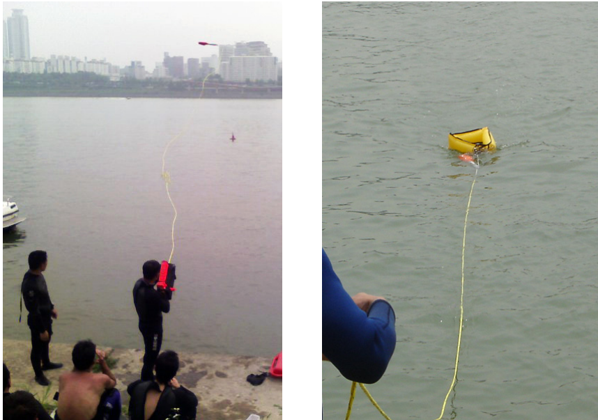
(그림 5-53) 구조로켓의 발사 모습. 로켓이 물에 닿으면 자동으로 구멍환이 펼쳐진다.
