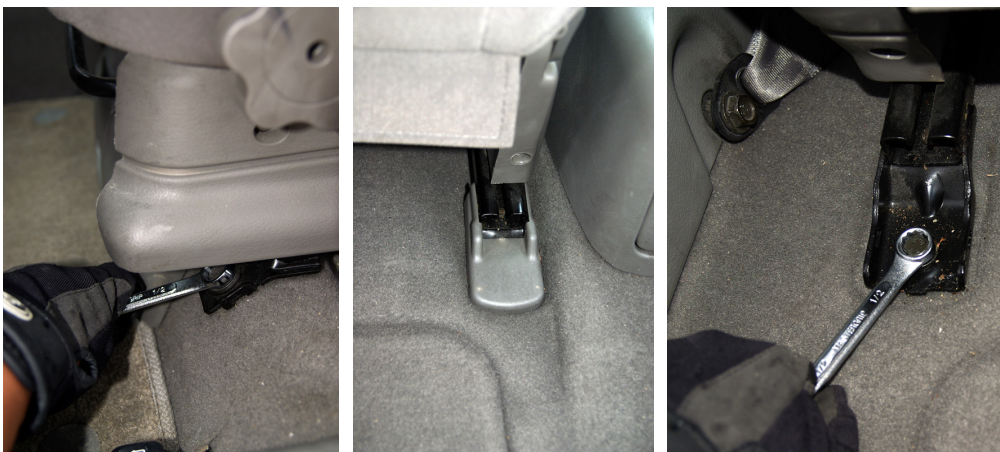
(그림 5-34) 운전석 의자를 분리하는 방법
