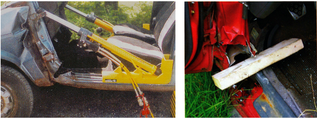
(그림 5-45) 유압램으로 프레임을 밀어내고 모서리에는 나무토막을 끼워둔다.
