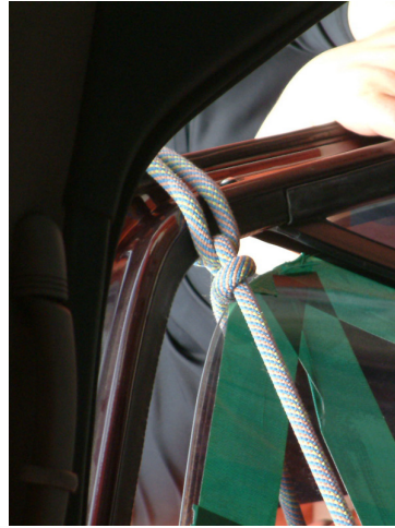
(그림 5-30) 페달에 로프를 묶고 반대쪽 끝은 창틀에 묶은 다음 문을 바깥쪽으로 젖힌다.
