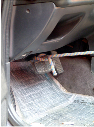
(그림 5-30) 페달에 로프를 묶고 반대쪽 끝은 창틀에 묶은 다음 문을 바깥쪽으로 젖힌다.
