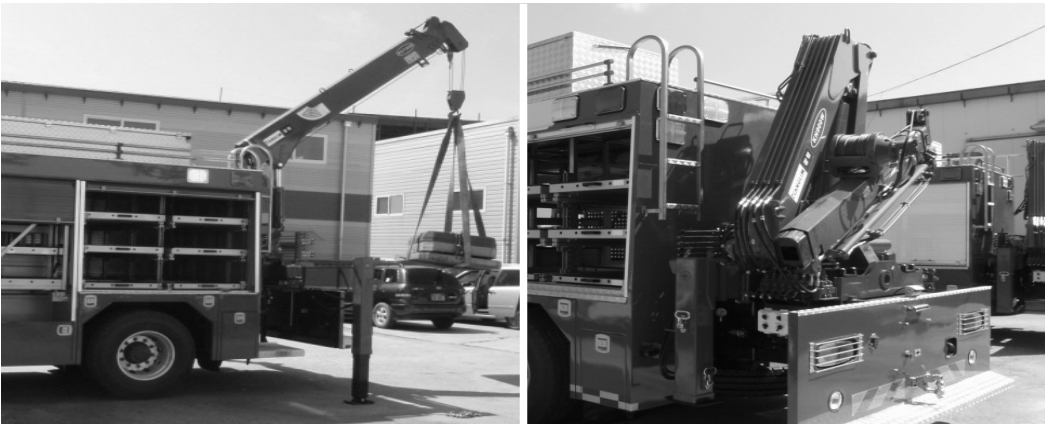
※ 크레인 작동 상태 및 와이어 상태 및 작동상태 그리스 도포 등을 확인한다.
