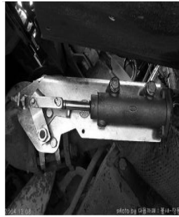
배기브레이크 장착 상태
