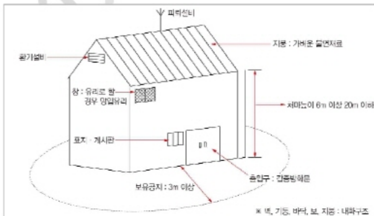
[단층건물의 고층식 고인화점 위험물 옥내저장소의 구조 예시]
